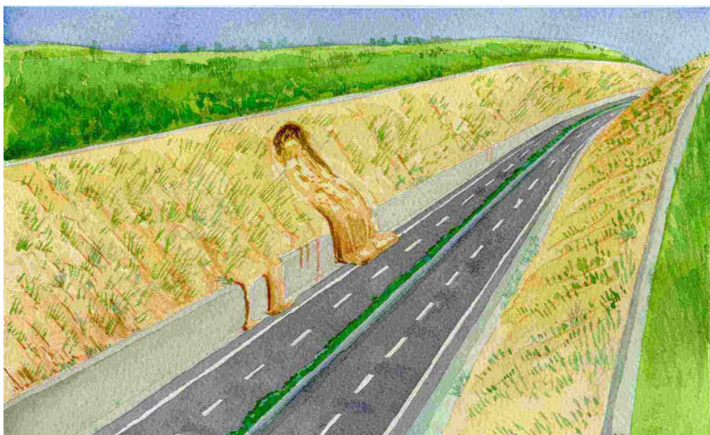
Fig. 5: Erosioni superficiali e colate di fango
