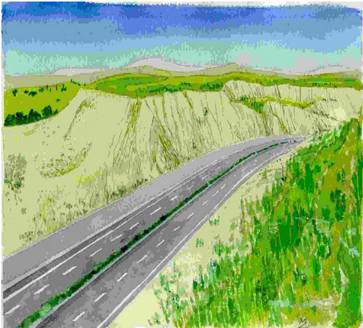
Fig. 10 - Dissesti che si verificano sulle pendici nei pressi delle pertinenze autostradali. E' essenziale conoscerle per valutare se la loro evoluzione possa creare riflessi negativi sulla sede viabile.
